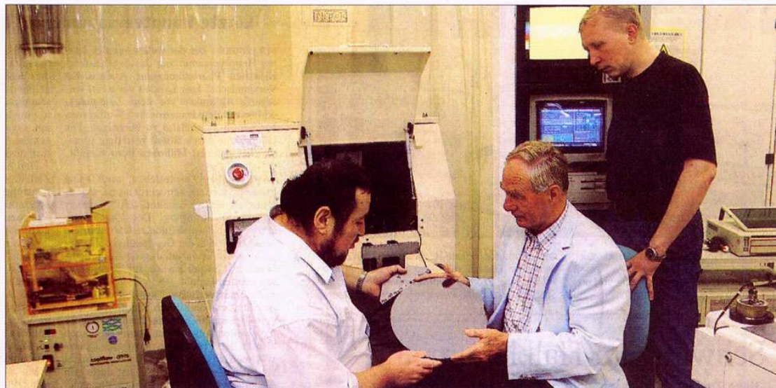
Am Laser-Scattering-Tomographen untersuchen Prof. Dr. Hans Richter (Mitte), der russische Mitarbeiter Dr. Wladimir Achmetow (li.) und der ukrainische Doktorand Oleksandr Lysitzki Verteilung und Ausmaß von Verunreinigungen in 300-Millimeter-Silizium-Wafern.
