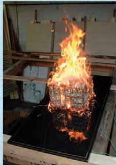
Prüfaufbau nach ENV 1187-1
