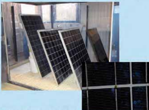
Salznebelkorrosionskammer und Korrosionsschäden an PV Modulen
