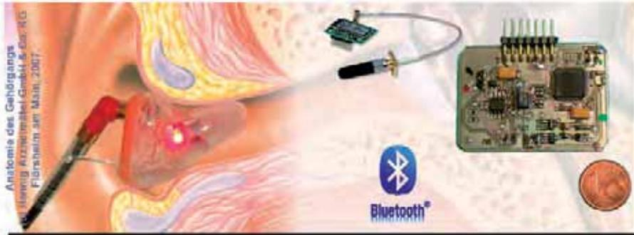
Individueller Im-Ohr-Sensor (otoplastik-integrierter VIP-Sensor)
